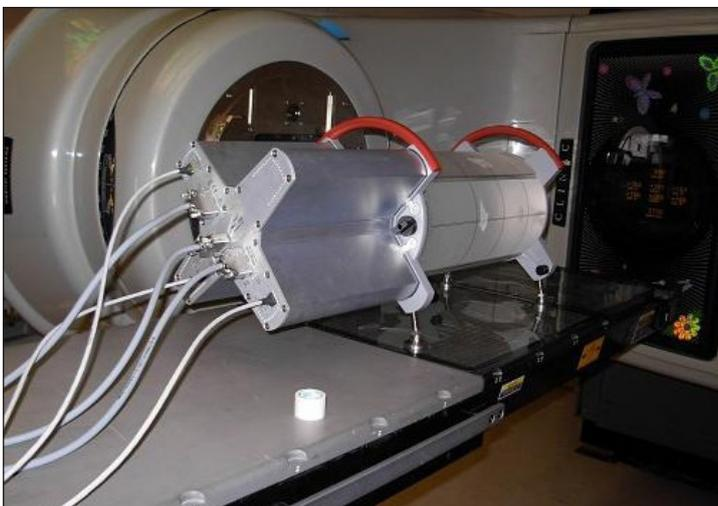
Figure 1. Le système Delta4® est composé de 1.069 diodes de mesure de dose disposées sur 2 plans perpendiculaires.
