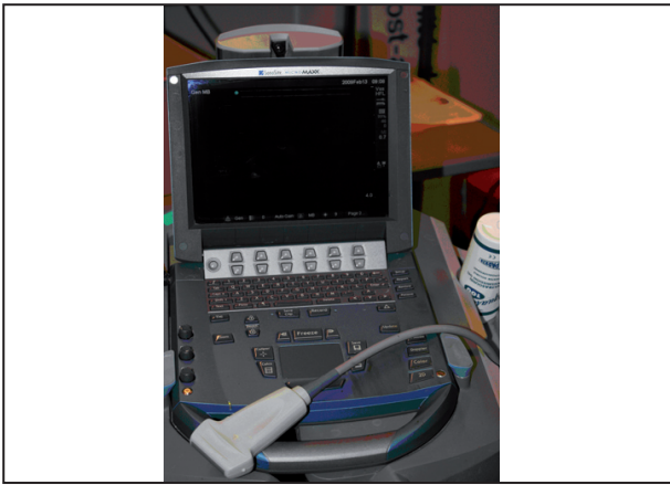
Figure 1. Echographe Sonosite® Titan Micromaxx (acquis par le service d'Anesthésie-Réanimation). Ce type d'échographe travaille avec des fréquences relativement élevées, permettant une bonne résolution des images pour les structures superficielles, de l'ordre de 1 à 6 centimètres. D'autres sondes sont disponibles pour une résolution plus en profondeur, mais peu utiles dans le cadre de cette utilisation.
