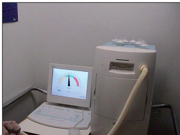
Figure 2. Appareil de mesure du monoxyde d'azote par chémoluminescence.
